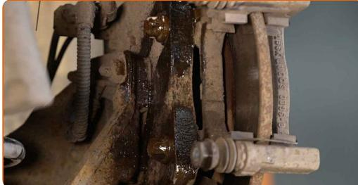
Udskiftning: bremseskiver – OPEL Corsa C Hatchback (X01). Råd fra AUTODOC:
