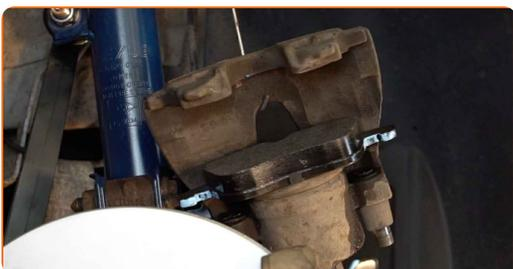
**28** Monter bremsekaliberen og sæt den fast. Brug HEX nr. H7. Brug en momentnøgle. Stram den til 28 Nm moment.
