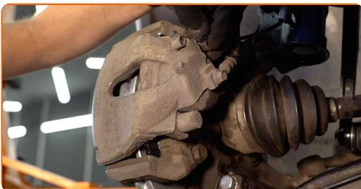
**30** Tilbagefør bremsekaliber låsefjederen tilbage på plads. Brug et koben.
