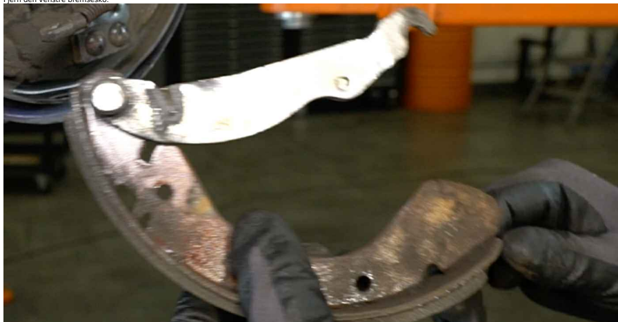
Udskiftning: bremsebakker - OPEL Corsa C Van (X01). Råd fra AUTODOC:
