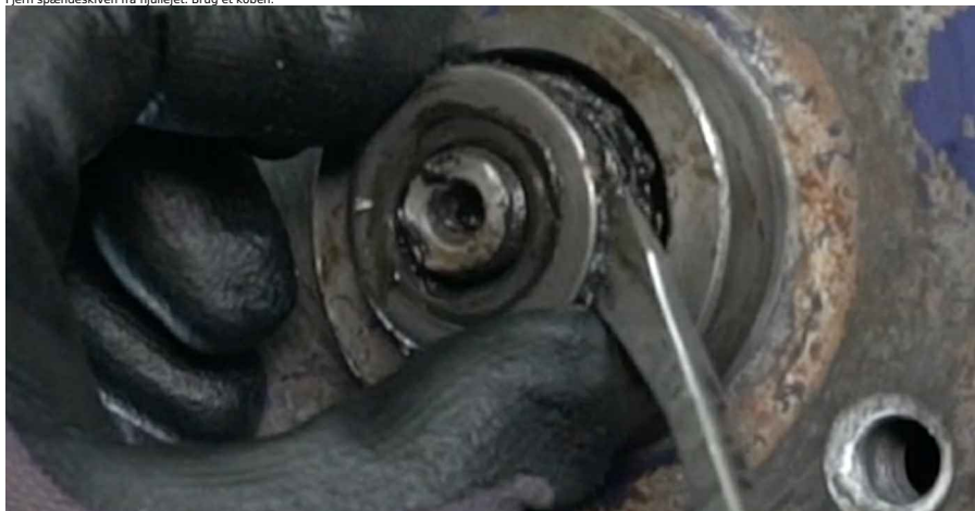
9 Fjern spændeskiven fra hjullejet. Brug et koben.
