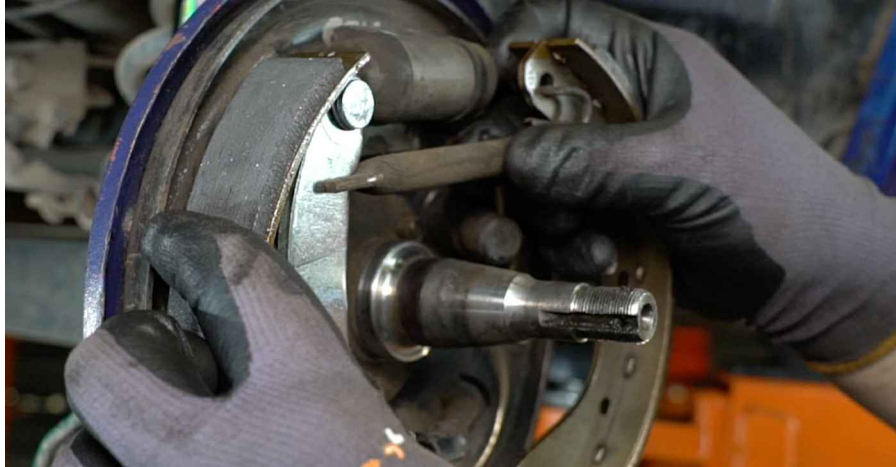
37 Installer den nedre returfeder.
