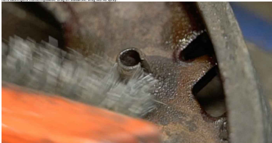
30 Fjern bøsningen. Brug vandpumpe tænger.
