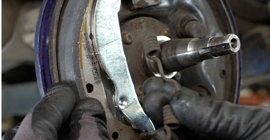
25 Installer den nedre returfeder.
