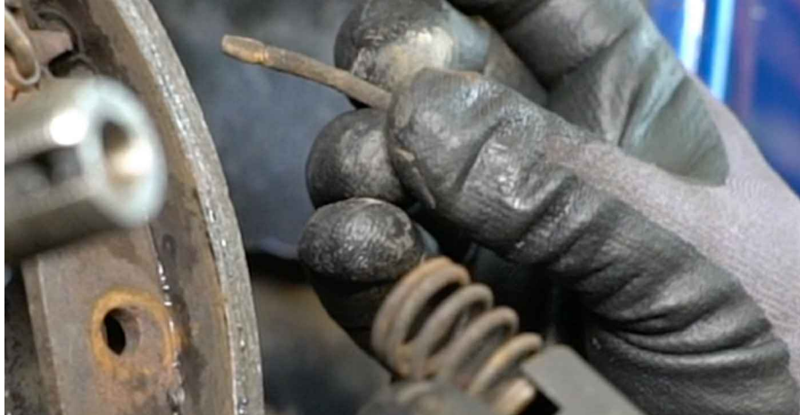
17 Adskil bremseskoen fra den underste fjeder.
