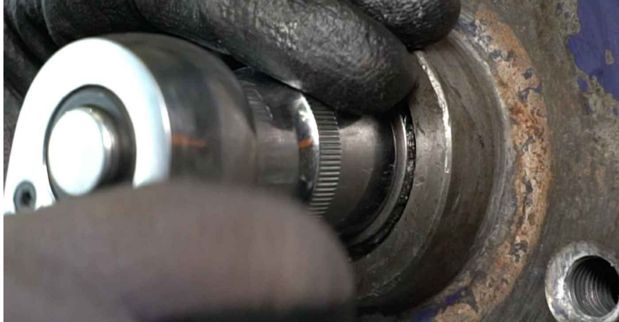
9 Fjern spændeskiven fra hjullejet. Brug et koben.
