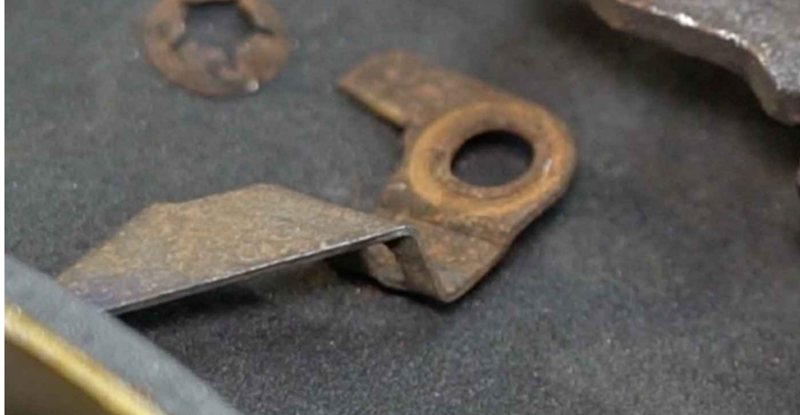
29 Rens bøsningens monteringssæde. Brug en stålberste. Brug WD-40 spray.
