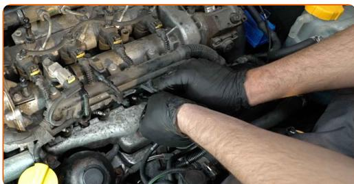
**15** Fjern mikrofiber håndklædet fra luftindsugningslangen.
