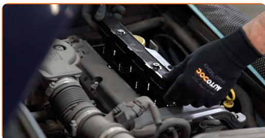
**8** Stram tændspolens skruer. Brug Torx T30. Brug en momentnøgle. Stram den til 15 Nm moment.
