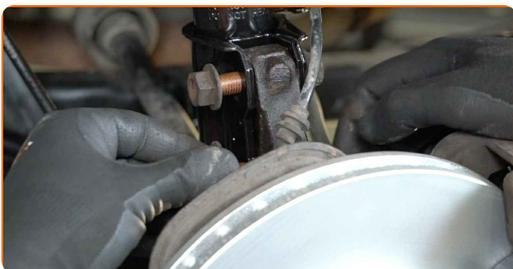
**55** Skru befæstigelseerne ind der forbinder fjederbenet med styrespindlen. Brug en kombinøgle № 18. Brug en topnøgle №18. Brug en skraldenøgle.
