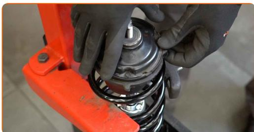
**46** Stram støddæmperstiverens plejlstangs møtrik. Brug en støæmper modhold topnøgle N°DD9. Brug en kombinøgle N° 18. Brug en momentnøgle. Stram den til 50 Nm moment.
