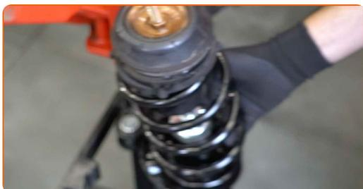
50 Rengør montagestedet til fjederbenet. Brug en stålbørste. Brug WD-40 spray.
