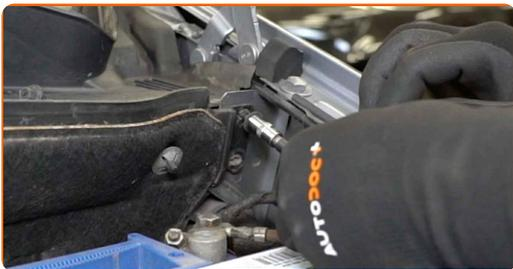
**10** Frigør torpedo-væggens panelclips.
