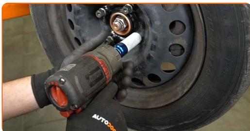
**66** Sænk bilen og stram hjulboltene på kryds med. Brug hjul slag nøgle #17. Brug en momentnøgle. Stram den til 110 Nm moment.
