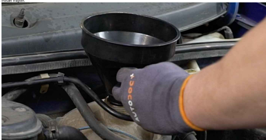
35 Hæld kølevæske på ekspansionsbeholderen.
