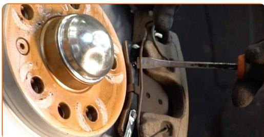
**15** Skru bremseslangen af bremsekalibren. Brug en topnøgle №11.
