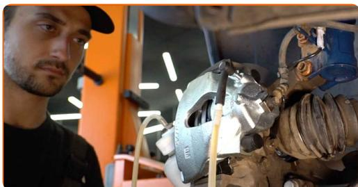
**31** Dræn bremsekaliber systemet. Tryk på bremsepedalen flere gange, indtil du kan mærke en betydelig modstand, uden at starte motoren.
