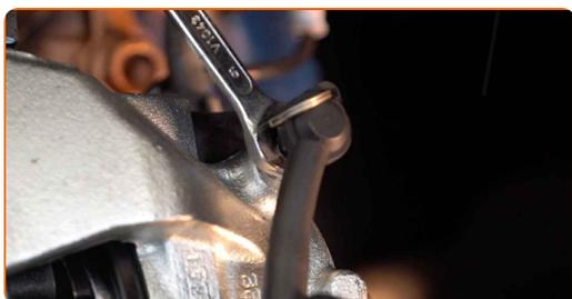
**33** Afbryd bremse udluftningssættet.
