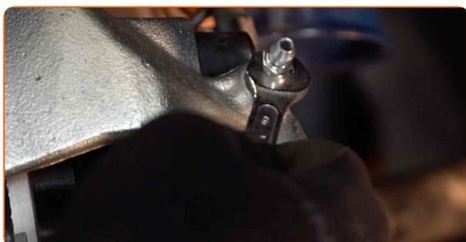
**30** Forbind bremse udluftningssættet til bremseudluftningsskuen.
