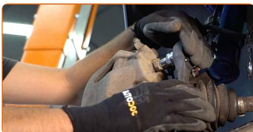
**11** Fjern støvhætter på bremsekaliberens styretapper. Brug et koben.
