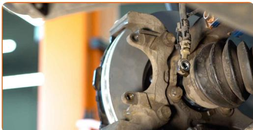
**Udskiftning: bremsekaliber – OPEL Meriva A (X03). AUTODOC eksperter anbefaler:**
