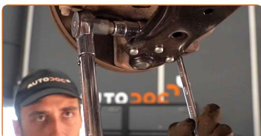
**23** Støt armen. Brug en hydraulisk løfteenhed.
