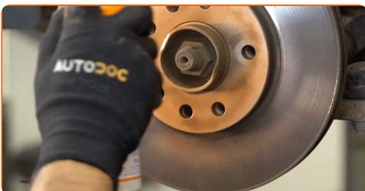
**31** Rengør bremseskivens overflade. Brug bremsrens.
