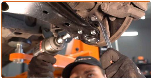
**22** Stram kugleledet fastgørelse. Brug en topnøgle №19. Brug en kombinøgle №17. Brug en momentnøgle. Stram den til 50 Nm moment.
