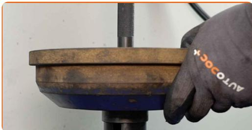
**17** Rengør navlejets monteringsæde. Brug universal rengøringsmiddel.
