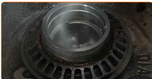
**18** Montér en ny ydre ring til hjullejet i bremsetromlen. Bøsnings-/ og lejeaftrækkersæt.
