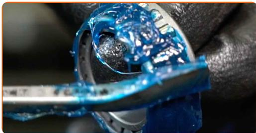
**21** Installer et nyt navleje og fastgør det.
