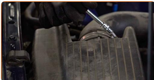
**5** Afbryd luftindsugningsrør fra luftfilterhuset.
