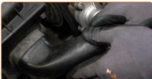
**32** Tilslut clipsen på luftindtagsslangen.
