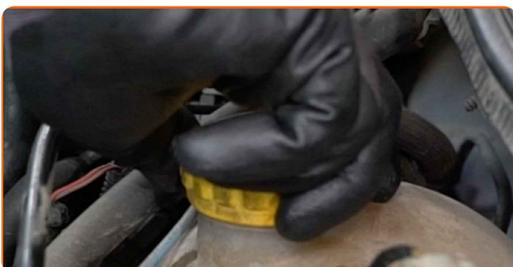
38 Tænd motoren og lad den køre i nogle minutter. Dette bør gøres for at fjerne resterende luft fra kølesystemet og for at efterse at komponenterne kører korrekt.
