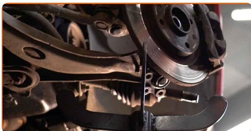
**26** Frigør den nedre befæstigelse der forbinder fjederbenet til stubakslen. Brug særlige skiftenøgler for at fjerne støddæmperen. Brug en skraldenøgle.
