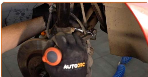
**59** Spænd befæstigelsen til der forbinder forbindelsesstangen med fjederbenet. Brug en topnøgle №17. Brug en momentnøgle. Stram den til 35 Nm moment.
