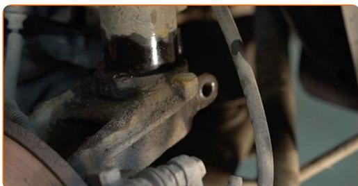
**25** Støt styrekuglen. Brug en hydraulisk løfteenhed.
