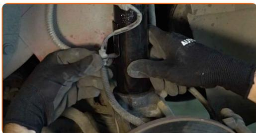
**58** Stram den nedre befæstigelses forbindelse mellem fjederben og styrespindel. Brug en topnøgle №16. Brug en momentnøgle. Stram den til 59 Nm moment.
