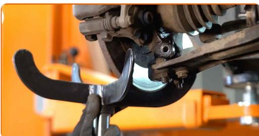
**10** Tag den nedre arm af styrekuglen. Brug et koben.
