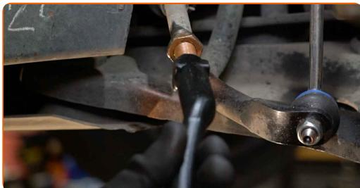
**Udskiftning: styrekugle – PEUGEOT 2008 Stationcar (CU\_). Råd fra AUTODOC eksperter:**
