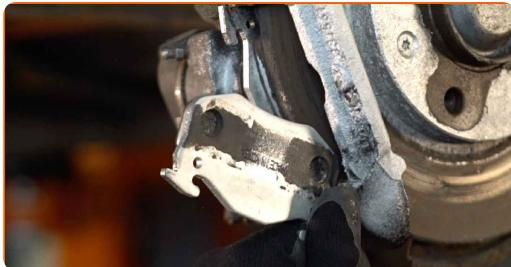
Udskiftning: bremseklodser – PEUGEOT 206 Hatchback (2A/C). Råd fra
