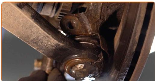
**15** Frigør befæstelserne som forbinder bæreamens styrekugle til styrespindlen. Brug en flad metalmejsel. Brug en hammer.
