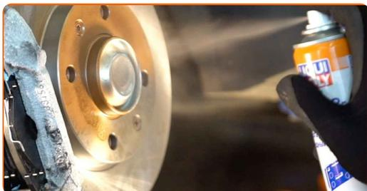
**29** Rengør bremseskivens overflade. Brug bremsrens.
