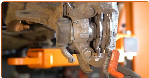
**10** Fjern låseclipsen til bremseklodserne. Brug et koben. Brug en gummihammer.
