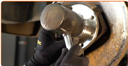
**26** Rengør navet. Brug en stålbørste. Behandl kontaktfladen. Brug kobberfedt.
