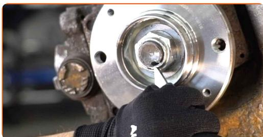
**25** Monter hjullejets beskyttelsehætte. Brug en gummihammer.
