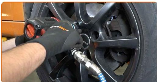
**34** Sænk bilen og stram hjulboltene på kryds med. Brug hjul slagnøgle #17. Brug en momentnøgle. Stram den til 100 Nm moment.
