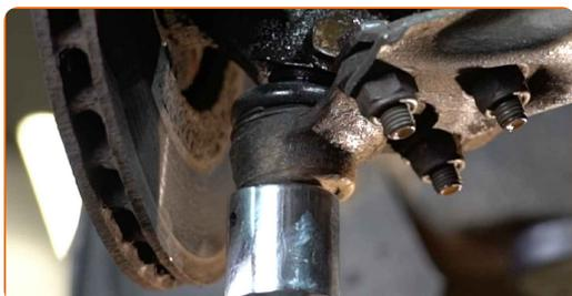
**26** Skru kugleleddets beslag af styrekuglen. Brug en kombinøgle № 16. Brug en topnøgle №16. Brug en skraldenøgle.
