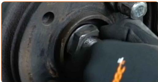
**21** Løsn drivakslen fra navet. Brug en drivdorn. Brug en hammer.
