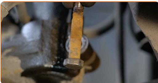
**33** Frigør den nedre befæstigelse der forbinder fjederbenet til stubakslen. Brug en flad metalmejsel. Brug en hammer.
