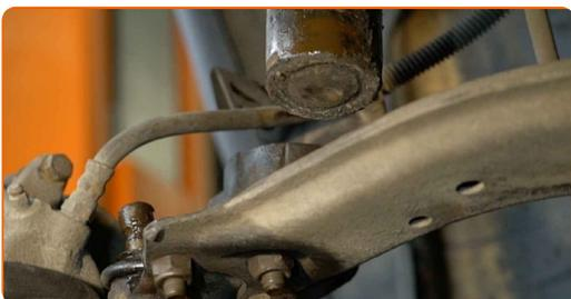
**35** Støt styrekuglen. Brug en hydraulisk løfteenhed.
