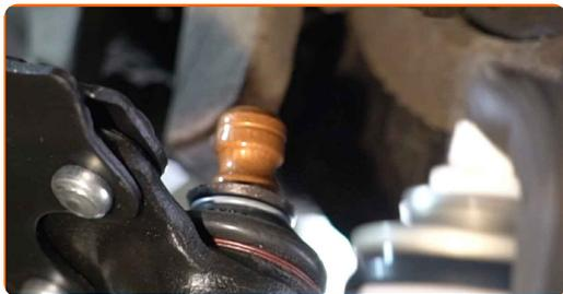
**66** Frigør befæstigelse som forbinder bæreamens styrekugle til styrespindlen. Brug en flad metalmejsel. Brug en hammer.
