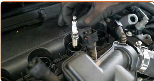
**10** Skru nye tændrør i og stram dem. Brug den 12-kantede tændrørsnøgle # 14. Brug en momentnøgle. Stram den til 23 Nm moment.
