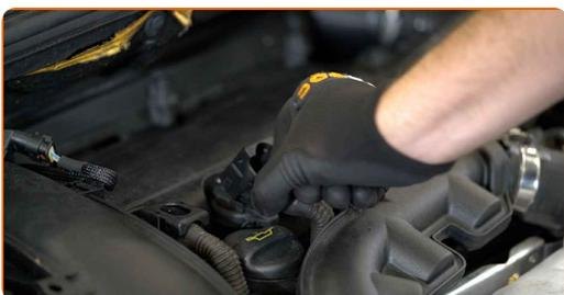
**4** Træk tændspolen op. Brug et koblen. Tag tændspolen ud af tændrørsfordybning.
