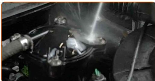
**13** Klargør brændstofsystemet manuelt ved at pumpe brændstof ind og derved fjerne tilbageværende luft.
