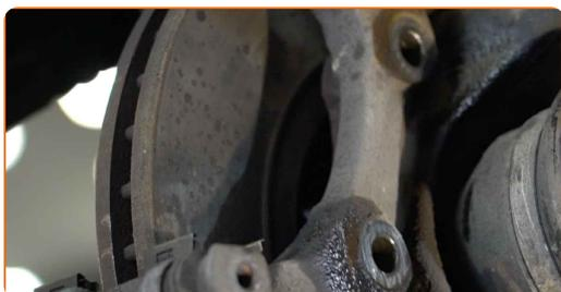
15 Rengør bremseskivebefæstigelsen. Brug en stålbørste. Brug WD-40 spray.
