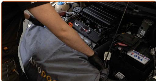
**3** Træk poly V-rem remstrammeren til side. Brug en kombinøgle № 16.
