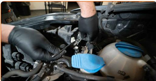
**3** Frigør pæren ved at dreje den ~ 30°. Fjern holderen fra forlygtens monteringssæde.
