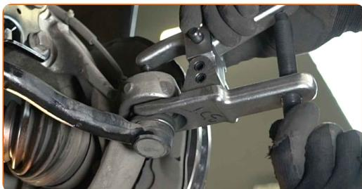
**12** Skru enden ud af sporingstangen. Brug en kombinøgle № 19.
