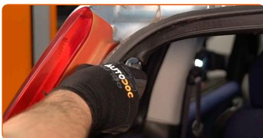
**9** Klem låseringen på der forbinder gasfjederen til karosseriet.
