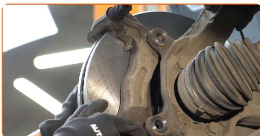
**20** Stram bremsekaliberens beslag. Brug en topnøgle №19. Brug en momentnøgle. Stram den til 152 Nm moment.
