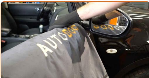
2 Brug malertape for at forhindre plastik og lakeret dele af bilen i at blive skadet.
