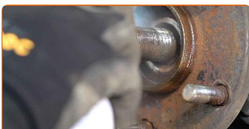
**20** Fjern kardanakslen. Brug en drivdorn. Brug en hammer.
