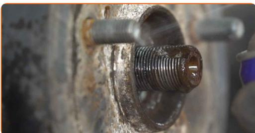
**11** Fjern kardanakslen. Brug en drivdorn. Brug en hammer.
