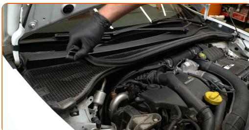
**4** Fjern torpedopladens clips. Brug et panelclip værktøj.
