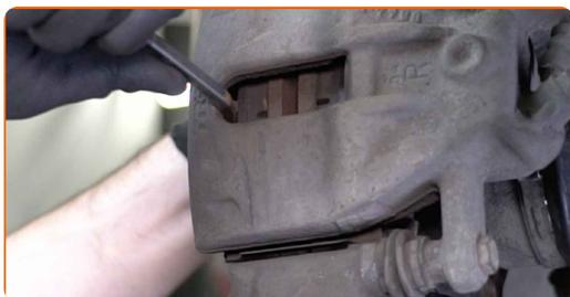
9 Rengør bremsekaliberens fastgørelser. Brug en stålbørste. Brug WD-40 spray.
