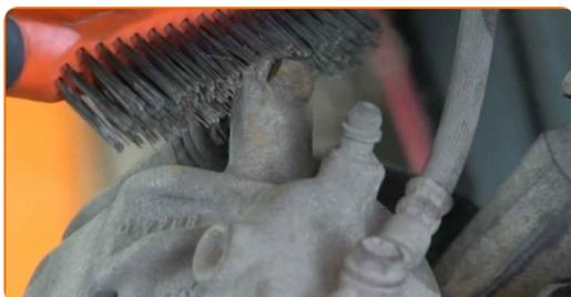
10 Skru fastgørelserne til bremsekaliberen af. Brug en kombinøgle N°13. Brug en kombinøgle N°15.
