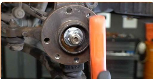
**23** Behandl kontaktfladen. Brug keramisk fedt.
