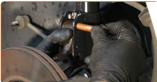
**53** Skru fastgørelsen ind som forbinder fjederbenet med styrekuglen. Brug en kombinøgle № 18. Brug en topnøgle №18. Brug en skraldenøgle.
