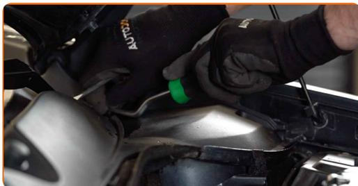
**4** Hæv fjederbenets montagedæksel en smule. Behandl befæstigelsen på fjederben belslaget. Brug WD-40 spray.
