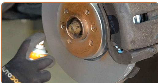
**19** Rengør bremseklodsens overflade. Brug bremserens.
