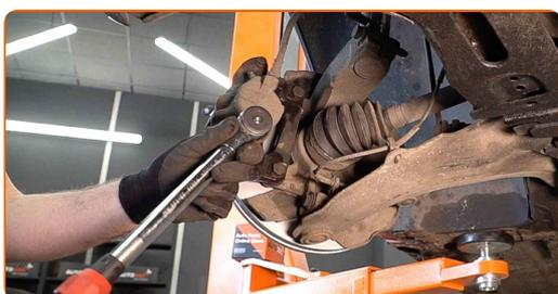
**18** Behandle overfladen hvor bremseklodsen har kontaktflade til hjulnavet. Brug kobberfedt.
