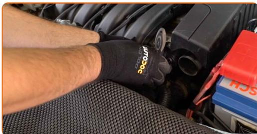
17 Forbind luftindsugningsslagen til luftfilterkammeret.
