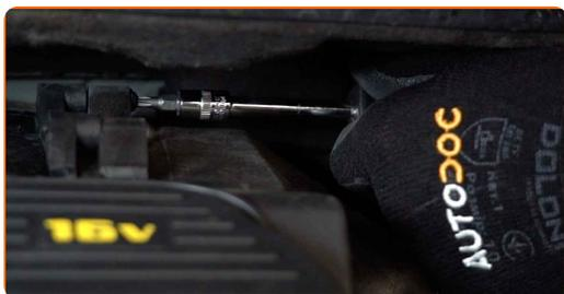
14 Forbind krumtaphus ventilationslangen til indsugningsmanifolderen.
