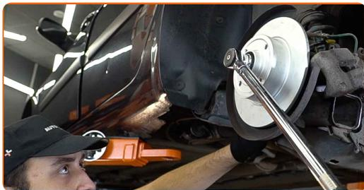
**20** Behandel navet på kontaktfladen med bremseskiven. Brug en universal smørefedt.
