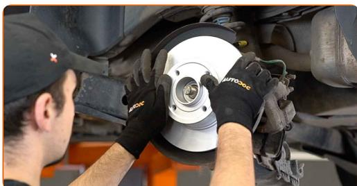
**19** Skru hjulnavets løsemøtrik på. Brug en topnøgle N°30. Brug en momentnøgle. Stram den til 175 Nm moment.
