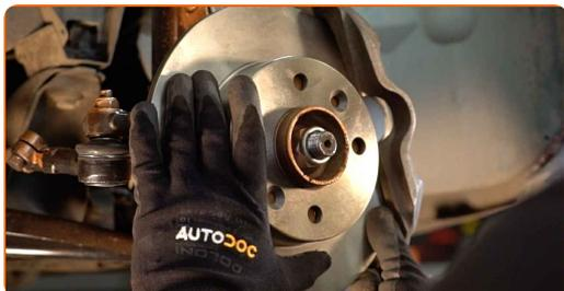
**19** Stram bremsekivens skruer. Brug Torx T30. Brug en momentnøgle. Stram den til 15 Nm moment.
