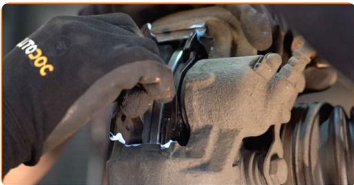
**21** Installer låseclipsen til bremseklodserne.
