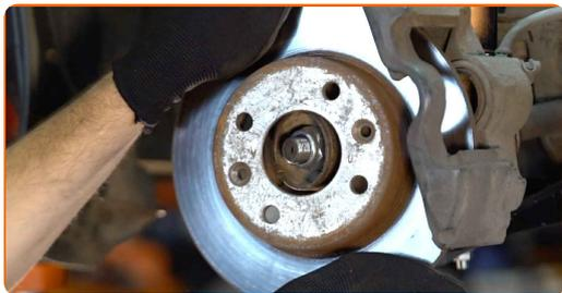
**14** Rens bremsekaliberens beslag for skidt og støv. Brug en stålbørste. Brug bremserens.
