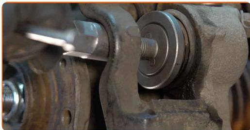
**17** Rengør navet. Brug en stålbørste. Behandl kontakthuden. Brug kobberfedt.
