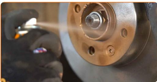
**24** Rengør bremseklodserens overflade. Brug bremserens.
