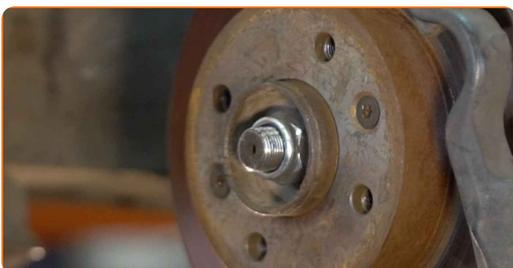
**12** Skru bremseeskivens skruer af. Brug Torx T30. Brug en slagskruetrækker.
