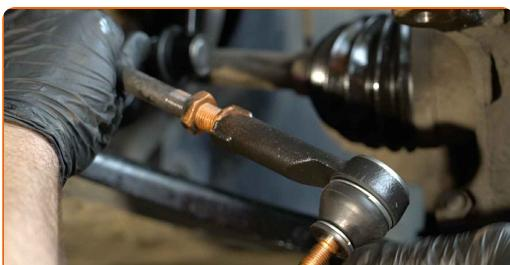
Udskiftning: styrekugle – RENAULT Twingo III Hatchback (BCM). Råd fra AUTODOC:
