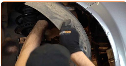
**10** Løsen befæstigelse der forbinder kofanger forstærkningsstangen til underrammen. Brug en topnøgle №13.
