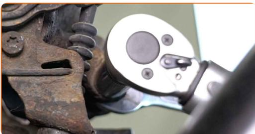
**40** Benhandel bremseklods slidsensor proppen. Brug dielektrisk fedt.
