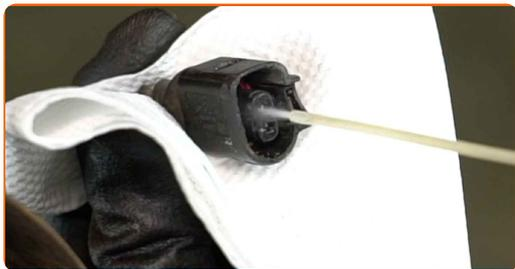
**41** Isæt stikket til bremseklods slidsensoren.
