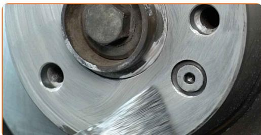
**44** Rengør bremseklodens overflade. Brug bremserens.
