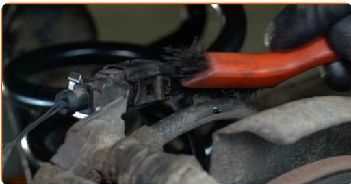
**8** Træk stikket ud til bremseklods slidsensoren.
