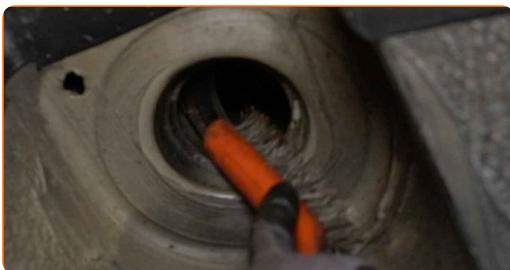
**55** Rengør de fastgørelser, der forbinder kugleleddet med styrespindlen. Brug en stålbørste. Brug WD-40 spray.
