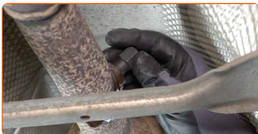
**12** Behandl oxygen sensoren. Brug varmebestandig keramisk fedt.
