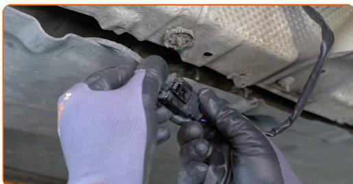
**17** Forbind ledningen til oxygen sensoren.
