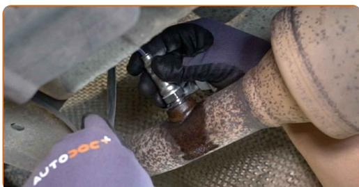
**14** Stram oxygen sensorens befæstigelse. Brug en åben ringnøgle #22. Brug en momentnøgle. Stram den til 37 Nm moment.
