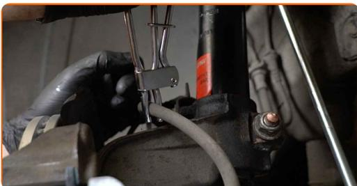
**26** Forbind bremse udluftningssættet til bremseudluftningsskuen.
