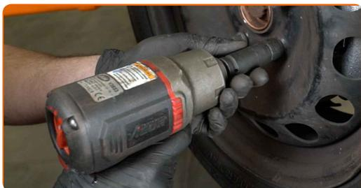
**35** Sænk bilen og stram hjulboltene på kryds med. Brug hjul slag nøgle #17. Brug en momentnøgle. Stram den til 120 Nm moment.
