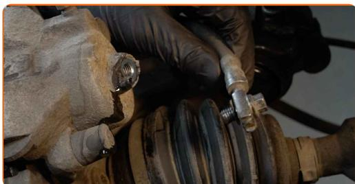
**12** Fjern støvhætter på bremsekaliberens styretapper. Brug et koben.
