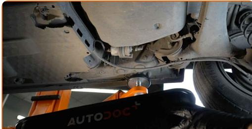
**5** Rengør befæstigelserne til brændstofslangerne. Brug en nylon rengøringsbørste. Brug universal rengøringsmiddel.
