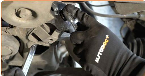
9 Tag kugleledet af styrekuglen. Brug en lejeaftrækker.
