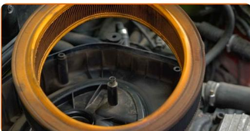
**7** Tildæk luftindsugningsslangen med et mikrofiber håndklæde for at undgå at støv og skidt kommer ind i systemet.
