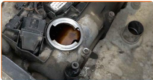
**25** Påsæt oliepåfyldnings studs. Skru oliepåfyldnings studs ind.
